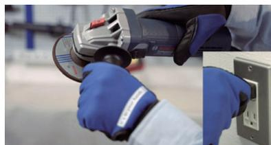
そのまま再びプラグをコンセントに差し込んでも、始動しません。メインスイッチを“OFF”にした後、“ON”にすると再始動します。
