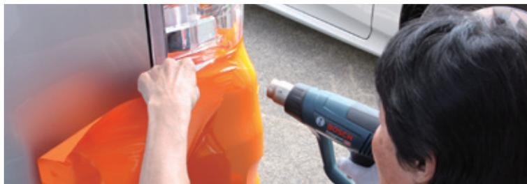
液晶ディスプレイに設定温度が表示されるので、フィルム指定の温度で温風を出すことができます。(GHG 23-66型)
